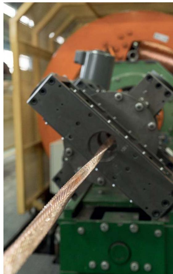
*Сегмент для жилы (изготовление кабеля сечением 2500 мм<sup>2</sup>, используемого при реконструкции Варшавского шоссе)*
