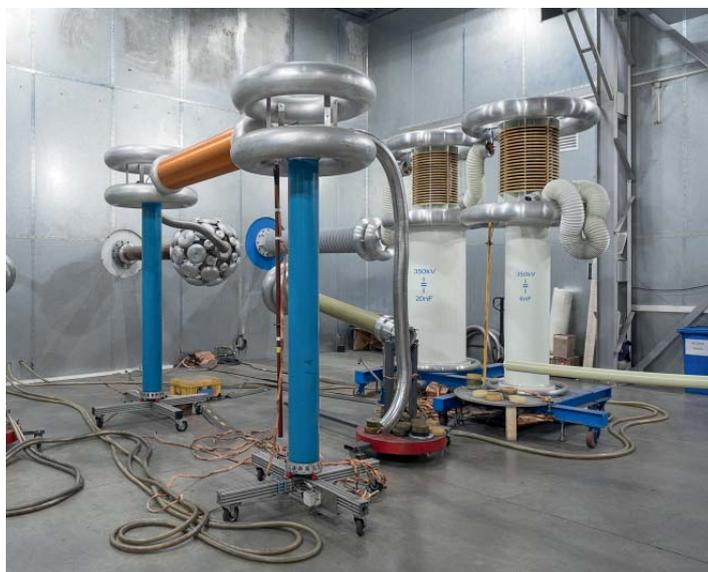
Лаборатория для высоковольтных испытаний кабеля
