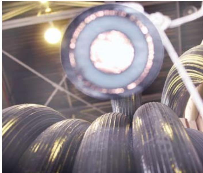
Кабели на напряжение 6-35 кВ и 110-220 кВ широко используются для передачи и распределения электроэнергии, особенно в крупных городах и на промышленных предприятиях, где уровень энергопотребления и плотности нагрузки чрезвычайно высоки. Стоимость кабеля составляет значительную часть от общей стоимости системы передачи электроэнергии, поэтому предъявляемые к кабелю требования по надежности, функциональности и низким затратам на обслуживание имеют огромное значение.
